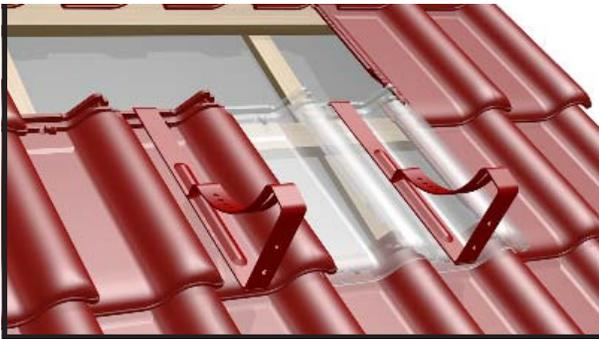
Установить крепление D на рейку. Профиль верхнего монтажного крюка крепления позволяет монтаж непосредственно на рейку, поддерживающую черепицу.
