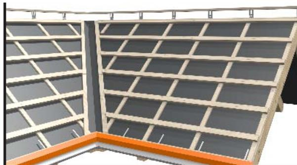
Соединение двух скатов выкладывают досками и застилают на них 3 слоя защитной мембраны. Ширина досок – мин. 35 см в каждую сторону, измеряется от середины ендовы. Контррейки и рейки обрезаются и крепятся к конструкции кровли.
