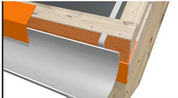
Пространство между рейками закрываем защитной решеткой от проникновения птиц. Ширина решетки должна быть соразмерной величине закрываемой поверхности.
