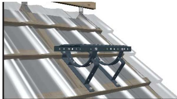
После установки второго, соседнего комплекта крепления с бугелем (с помощью прилагаемых болтов) установить решетку безопасности. Проверить качество монтажа, особенно - стабильность всех механических соединений.
