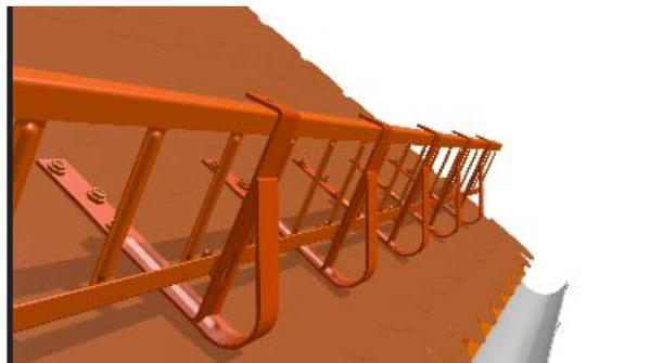
После установки необходимого количества креплений U устанавливают снегозадерживающую решетку. Решетка фиксируется в креплениях с помощью защелок. Последний этап – проверка надежности монтажа, особенно – всех механических соединений.
