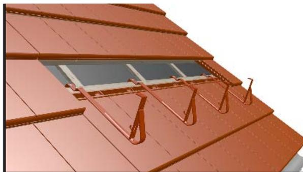
Крепление L зацепить на дополнительную монтажную рейку и зафиксировать самонарезами Ø8 мм.
