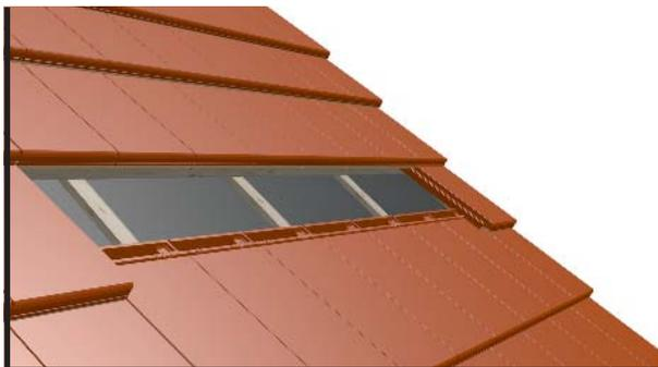
Снять черепицу на месте планируемой установки защиты от снега.
