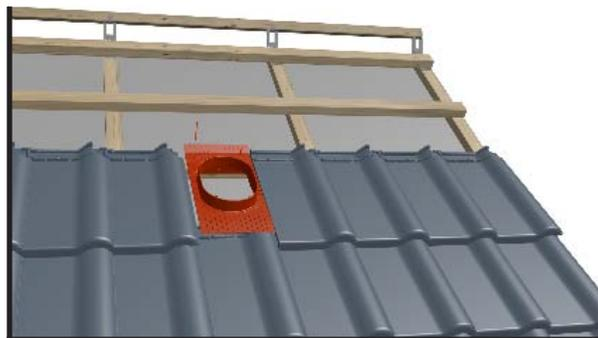
Нижнюю часть основания (крепление) прикрепить к брусу с помощью трех длинных самонарезов (два сверху, один в торце бруса). При необходимости можно дополнительно прикрепить нижнее основание к брусу (нижнего ряда черепицы) проволокой из нержавеющей стали к специально сформированным выступам в середине крепления.
