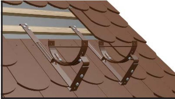
Бугель решетки безопасности разместить на креплении и выставить уровень. Обе части крепления плотно соединить с помощью прилагаемых болтов (2 шт./кронштейн).
