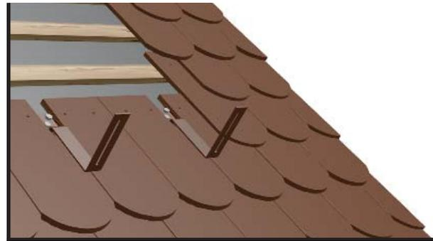
Нижнюю часть крепления S прикрепить непосредственно к конструкции кровли – самонарезами  $\varnothing 8$  мм.
