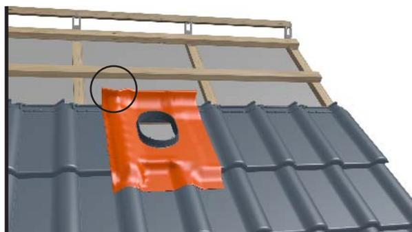
Спрофилировав боковые стороны и низ гибкого уплотнительного фланца, аккуратно приклеить его к покрытию кровли в направлении от крепления наружу (по сторонам и вниз). Край следует прижать н.п. с помощью кровельного прижимного валика. Верхнюю часть гибкого уплотнительного фланца отогнуть вверх и на покрытиях с керамической черепицей – отрезать лишнее (участок, который не стыкуется с верхним замком черепицы).
