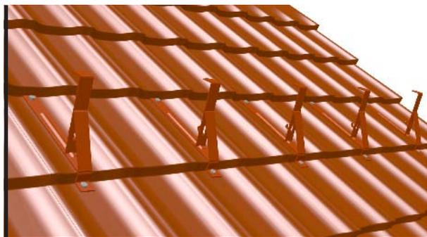
Крепление установить на покрытие из металлочерепицы и прикрепить непосредственно к деревянной конструкции кровли самонарезами Ø8 мм. Кровельным уплотнителем закрыть все монтажные отверстия в металлочерепице.
