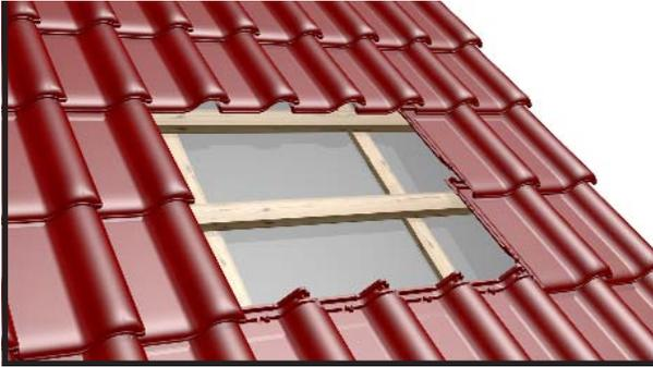
Снять часть черепицы на месте планируемого монтажа.
