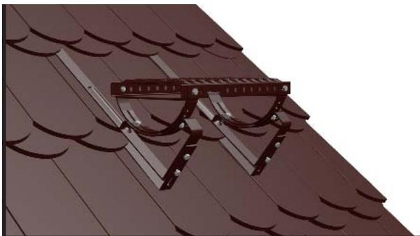
Крепления S или SD - универсальные элементы, используются для большинства моделей цементно-песчаной и керамической черепицы. Для черепицы „бобровый хвост” с чешуйчатой кладкой – используется крепление S. Крепление SD предназначено для венечной кладки. В обоих случаях шаг реек в месте крепления элементов кровельной безопасности должен быть ок. 16 см.
