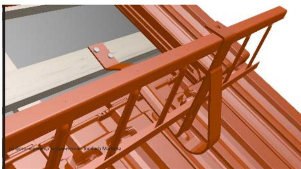
После установки необходимого количества креплений DB/DC устанавливают снегозадерживающую решетку. Решетка фиксируется в креплениях с помощью защелок.
