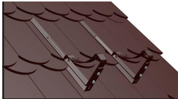
Уложить два следующих ряда черепицы. Внимание! Срезать боковой край в черепице, размещенной непосредственно на нижнем элементе крепления SD.
