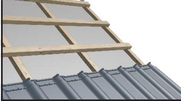
Установить ряд черепицы ниже планируемо места монтажа вентиляционного выхода.
