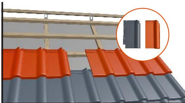
Установить ряд черепицы ниже места установки вентиляционного выхода. Установить минимум по три черепицы с левой и правой стороны места монтажа вентиляционного выхода Virtum<sup>®</sup>UNI. Срезать боковой замок на черепице, находящейся с правой стороны крепления.
