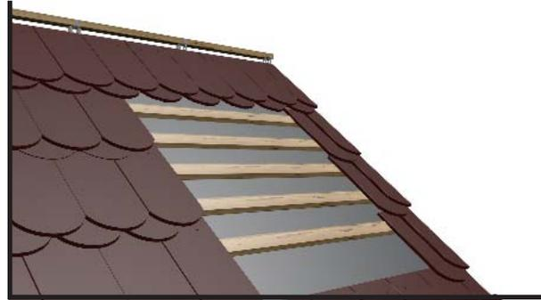
Для кровли с венечной кладкой черепицы „бобровый хвост” установить дополнительную монтажную рейку (на середине расстояния между рейками, поддерживающими черепицу).
