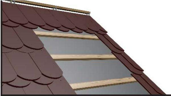
Снять черепицу на месте планируемого размещения крепления.
