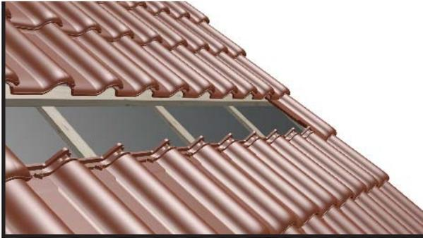
Снять черепицу на месте планируемой установки защиты от снега.
