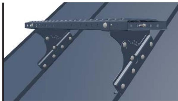
После установки второго крепления (с помощью прилагаемых болтов) установить решетку безопасности. Проверить качество монтажа, особенно - стабильность всех механических соединений.
