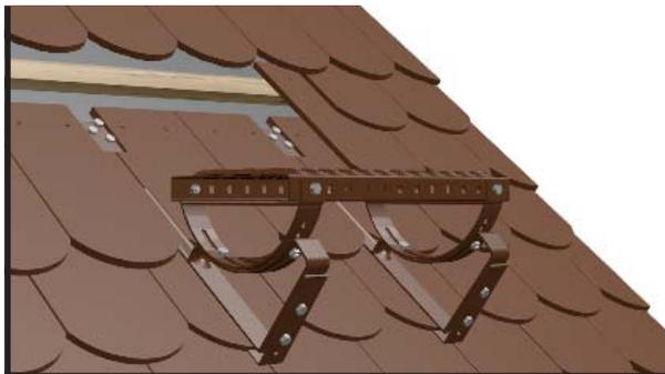
В черепице, которую планируем разместить на верхнем элементе, удаляем части затрудняющие установку. Край черепицы шлифуем (на глубину 5 мм и ширину 10 мм).
