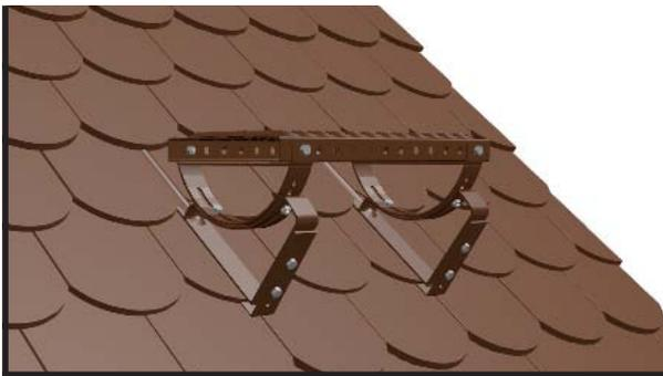
Крепления S или SD - универсальные элементы, используются для большинства моделей цементно-песчаной и керамической черепицы. Для черепицы „бобровый хвост” с чешуйчатой кладкой – используется крепление S. Крепление SD предназначено для венечной кладки. В обоих случаях шаг реек в месте крепления элементов кровельной безопасности должен быть ок. 16 см.
