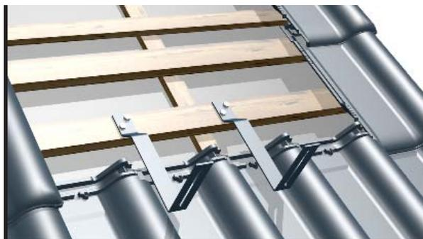
Следующий этап – установка нижнего элемента крепления (из двух частей) (тип DB/DC) к заранее установленной нижней монтажной рейке (болтами с шестигранной головкой).
