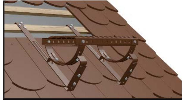
После установки второго, соседнего комплекта крепления с бугелем, установить решетку безопасности.
