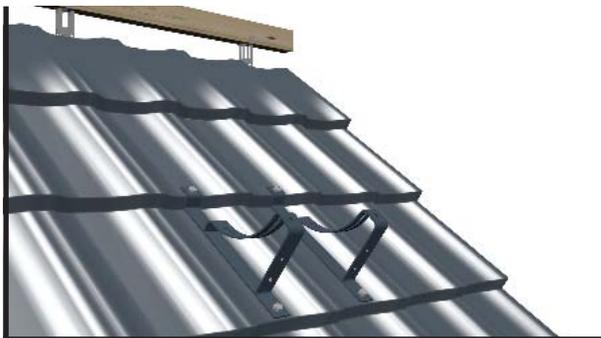
Крепление устанавливают на металлочерепицу и прикручивают непосредственно к деревянной конструкции кровли. Все монтажные отверстия закрыть кровельным уплотнителем.
