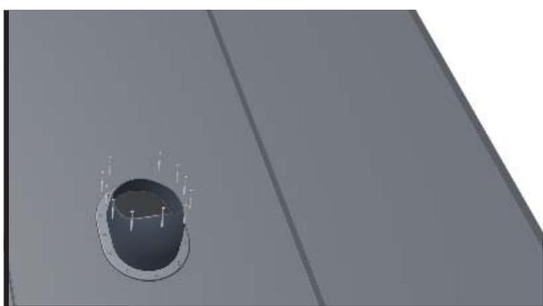
Снять защитную ленту бутил, затем установить вентиляционный выход.
