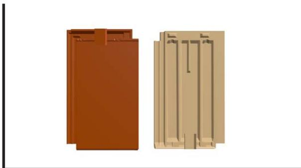
В черепице, находящейся ниже места установки крепления, сбить часть верхнего замка (для керамической черепицы). В черепице, укладываемой непосредственно на крепления, сбить часть нижнего замка (для керамической и цементно-песчаной черепицы).
