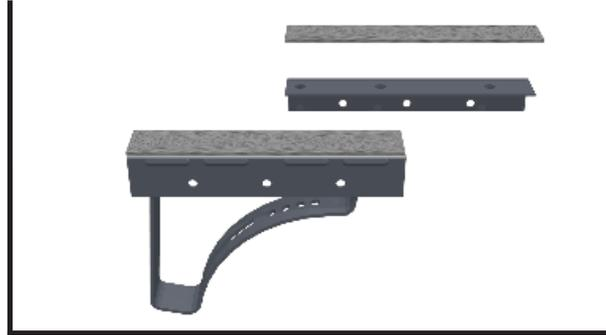
Оба основания коннектора, состоящего из двух частей, подклеить защитными лентами из пенополиуретановой пенки. Внимание – ленты приклеиваются на болты! Не допускается образование отверстий в лентах.
