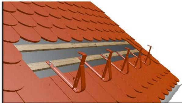
Крепление S установить непосредственно на деревянной конструкции кровли самонарезами Ø8 мм.
