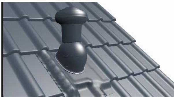
Установить вентиляционный выход на основу VIRTUM® (вентиляционный выход следует подключить к вентиляционному проводу – н.п. с помощью мягкого соединения mdm®). После фиксации вентиляционного выхода в вертикальном положении (с помощью уровня, который находится в верхней части) прикрепить его к верхней части основания с помощью четырех коротких самонарезов.
