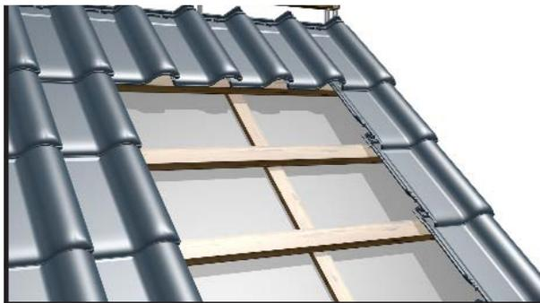
Снять часть черепицы на месте планируемого монтажа.
