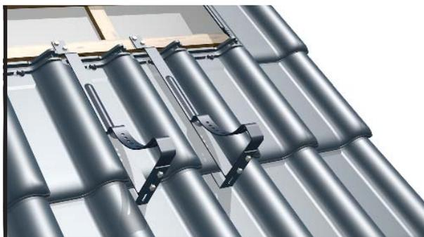
После укладки очередного ряда черепицы, аналогично устанавливаем второй элемент крепления DB/DC.
