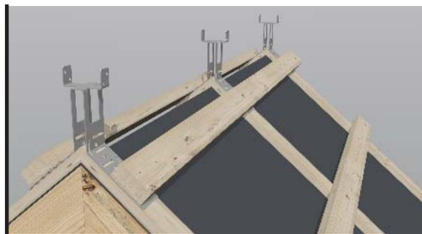
Приступаем к установке реек. Шаг установки реек зависит от модели черепицы. Установку начинают от линии ската. Подконьковая рейка крепится на расстоянии 3,5-4,5 см от конька кровли.
