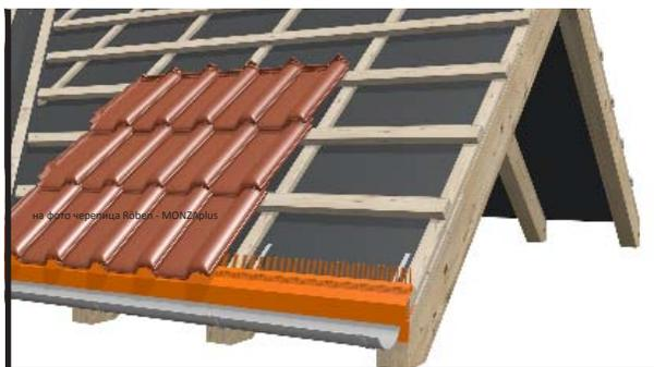
Продукт – в варианте соответственно типу кровельного покрытия – разместить на участке свеса (над водостоком) и прикрепить самонарезами к брусу свеса.
