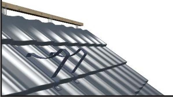
Крепление устанавливают на настил из металлочерепицы и прикручивают непосредственно к деревянной конструкции кровли. Все монтажные отверстия закрыть кровельным уплотнителем.
