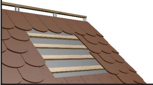
Снять часть черепицы на месте планируемого монтажа.
