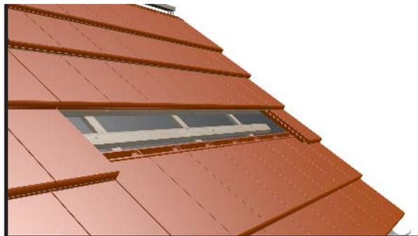
Прикрепить дополнительную монтажную рейку к конструкции кровли. Высота установки рейки зависит от модели черепицы.
