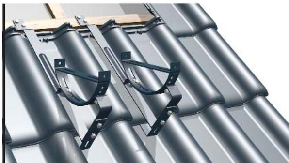
На креплении разместить и выставить уровень бугеля решетки безопасности. Оба элемента плотно соединить (с помощью прилагаемых болтов 2 шт./ бугель).
