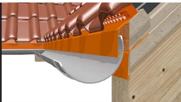
После установки контрреек и реек прикрепить крепления водостока и карнизную планку (листовую или в рулоне).
