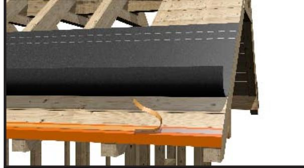
Монтаж мембраны начинают от линии свеса - мембрану укладывают параллельно краю свеса. Нижний край мембраны плотно приклеивают к планке свеса – н.п. бутиловым клеем или двухсторонним скотчем.
