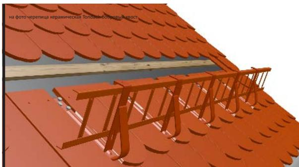
После установки необходимого количества креплений S устанавливают снегозадерживающую решетку. Решетка монтируется в крепления с помощью защелок.
