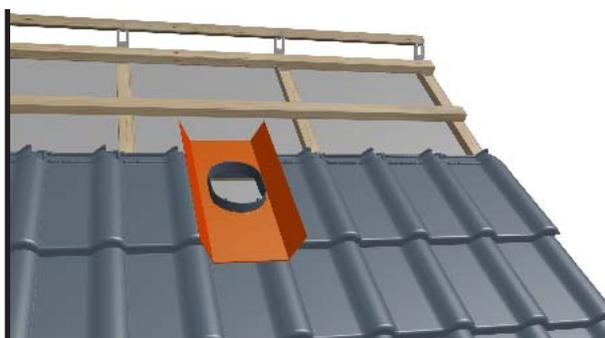
Не снимая защитной прокладки с бутилового клея, предварительно установить гибкий уплотнительный фланец UNI на покрытие кровли и в случае необходимости - укоротить его. Снять прокладку с гибкого уплотнительного фланца UNI и плотно приклеить его к кронштейну. Внимание – на данном этапе не приклеивать гибкий уплотнительный фланец к покрытию кровли.
