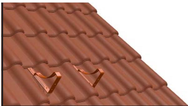
После установки верхнего ряда черепицы уплотнить места сбитых замков - нп. кровельным уплотнителем.
