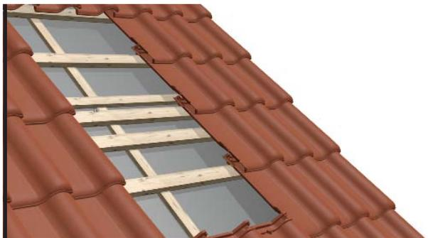
Установить две дополнительные монтажные рейки на конструкцию кровли (высота ок. 2,5 см – в месте установки крепления) и стандартную рейку в месте нижней точки упора крепления). Высота установленных реек зависит от модели черепицы.
