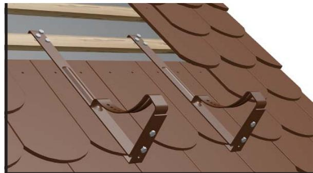
Прикрепить верхнюю часть крепления S – самонарезами  $\varnothing 8$  мм. Обе части крепления плотно соединить (с помощью прилагаемых болтов).
