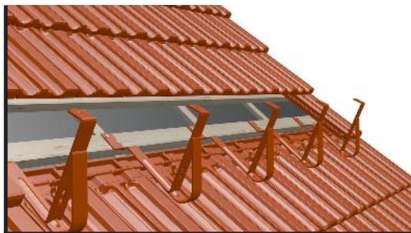
Крепление DB/DC зафиксировать непосредственно на деревянной конструкции кровли самонарезами Ø8 мм.
