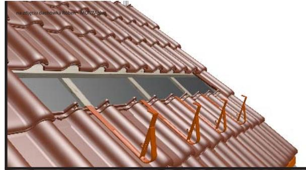
Для креплений D не нужна установка дополнительной монтажной рейки. Крепление D зацепить на рейку, поддерживающую черепицу и зафиксировать самонарезами Ø8 мм.
