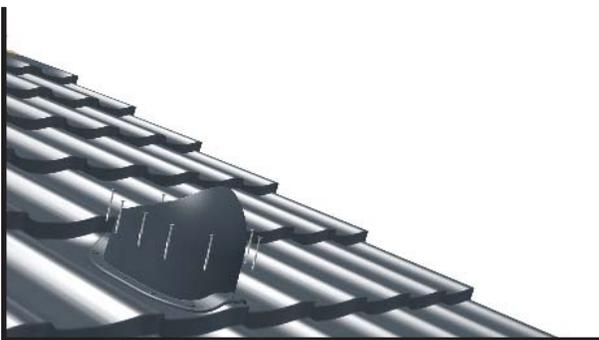
Снять защитную ленту бутил на основании, затем установить вентиляционный выход.
