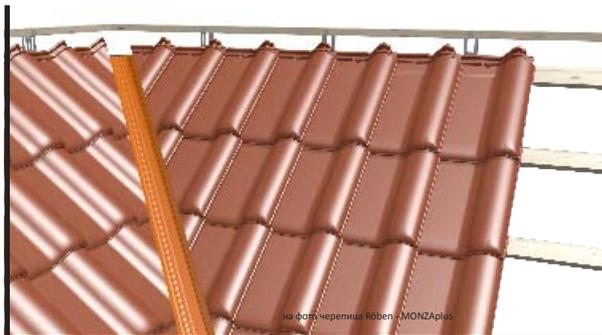
Место обрезания черепицы определяется заранее принятой шириной ендовы. Для ендовы до 8 м оставляется мин. 5 см зазор между осью ендовы и краем покрытия кровли. Для ендовы длиной >8 м – пропорционально увеличивается зазор. Обрезанную черепицу закрепляем специальными зажимами для обрезной черепицы.
