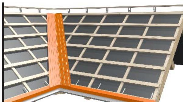
Желоба ендовы mdm® покрыты защитной пленкой (снять после установки желоба).
