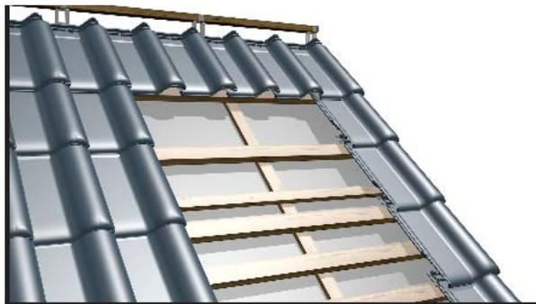
Установить две дополнительные монтажные рейки на конструкцию кровли (высота ок. 2,5 см – в месте установки крепления и стандартную рейку в месте нижней точки упора крепления). Высота установленных реек зависит от модели черепицы.
